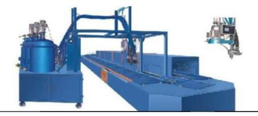
Fig. 3: PU pouring Machine.
